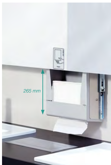
Papierhandtuchspender mit Hilfe der Führungsschiene zum Nachfüllen herabgezogen. Achten Sie bereits bei der Planung auf genügend Abstand zum Waschtisch, damit der Spender vollständig heruntergezogen werden kann – am besten, ohne die Waschtischplatte zu berühren.
