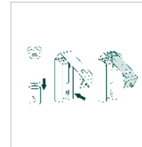
Sprüheinheit zur Befüllung entnehmbar
