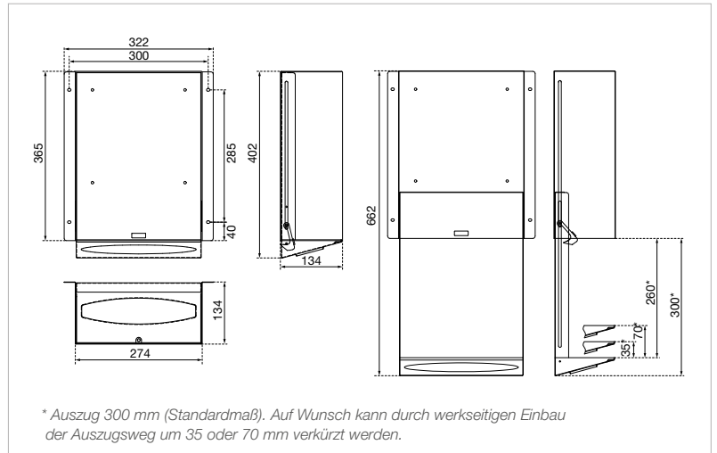
Art. 20-167: technische Zeichnung für herausziehbaren Hinter-Spiegel-Papierhandtuchspender, auf genügend Abstand zum Waschtisch achten, Auszugsweg 300 mm
