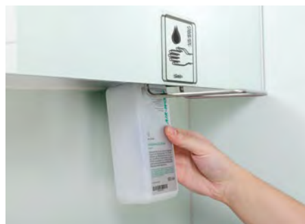
Flaschenwechsel von unten. Einen Montageabstand von mindestens 150 mm vom Spender zum Waschtisch einhalten, damit die Flasche gewechselt werden kann.
