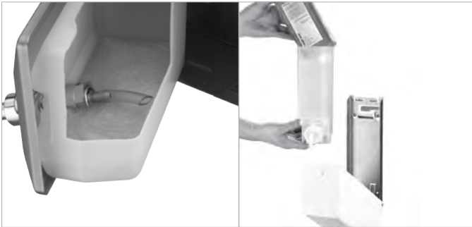
Falsch: Behälter zur Reinigung nicht entnehmbar, Pumpe nicht am tiefsten Punkt und entleert ihn dadurch nicht vollständig
